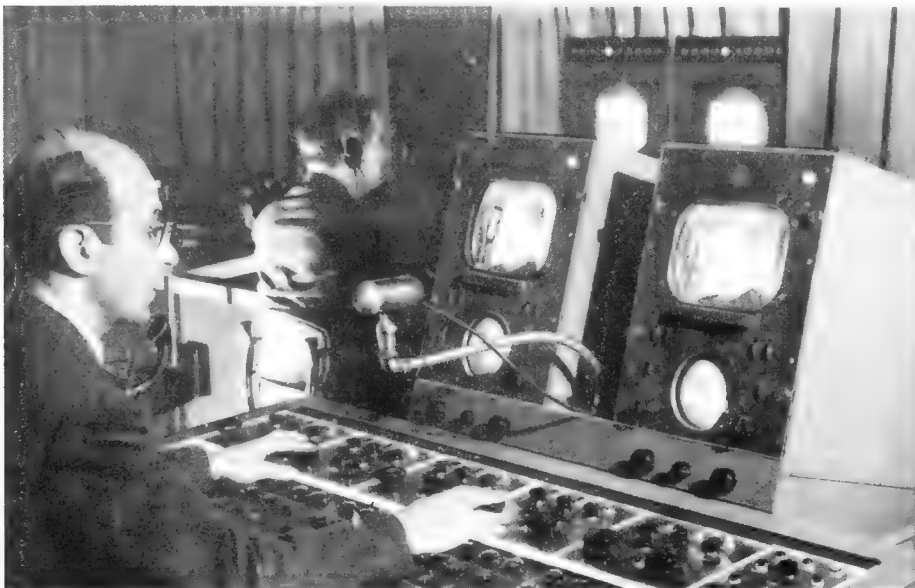
Bild 1. Am Regelpult des Bildingenieurs sind mit Oszilloskopen kombinierte Fernsehrohren angeordnet, die die Bildüberwachung vereinfachen
